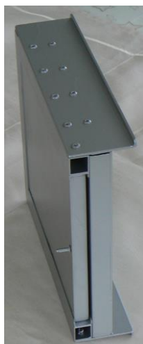
Filtr podstawowy z wsuniętym kompletem filtrów (np. w teście AEC przy zmianie grubości obiektu i napięciu lampy powyżej 100 kV)
