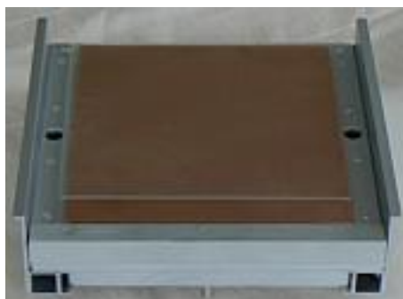
Filtr podstawowy z wsuniętym kompletem filtrów (np. w teście AEC przy zmianie grubości obiektu i napięciu lampy powyżej 100 kV)
